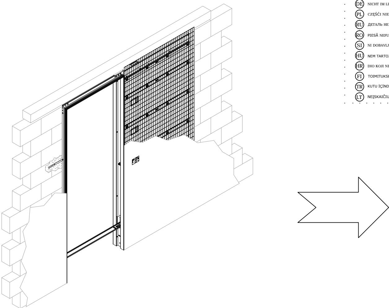
**IT**) Importante: Nella parte superiore della struttura applicare un travetto/architrave che non deve appoggiare direttamente sul controtelaio. INTONACATURA: 1) Preparare una malta cementizia usando inerte di sabbia pulita (lavata) granulo 3 e cemento 15%. NB. Rinzaffare fino a rasare la rete. TASSATIVO: LASCIARE ASCIUGARE PER 15 GIORNI. 2) Applicare la successiva mano di intonaco per finitura con un impasto adeguato.
